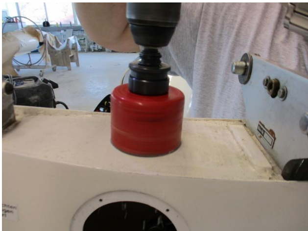
Lochsäge Ø 67 mm – Achtung: nur die oberen Lagen bis zum Schaum durchsägen Hole saw (lock saw) Ø 67 mm – Caution: only sever the upper layers until reaching the foam
